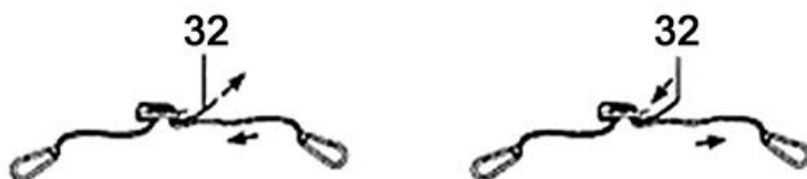
HEVEDER RÖVIDÍTÉSE HOSSZABBÍTÁSA
